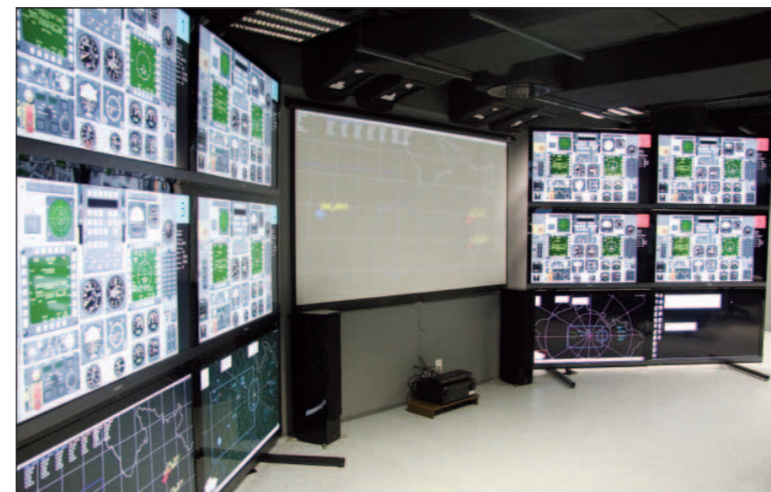
■ Na velkoplošných obrazovkách pro pozorovatele v simulační hale se promítá celková taktická situace (uprostřed) a letová data a přístrojové desky jednotlivých cvičících
