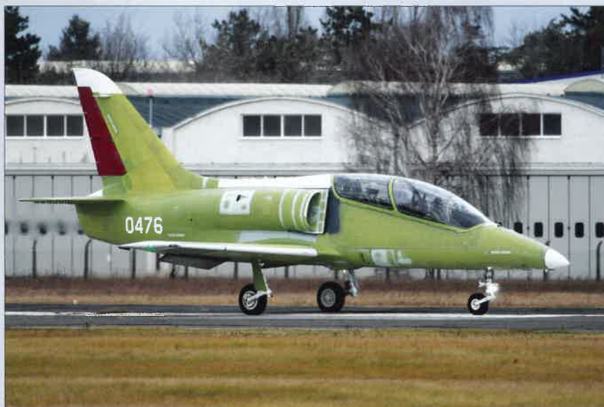
Předsériový letoun výrobního čísla 167004 byl postaven v souladu s finální specifikací pro sériovou výrobu. Později, po absolvování zkušebnímu programu a získání certifikace, by mohl být dodán zákazníkovi
