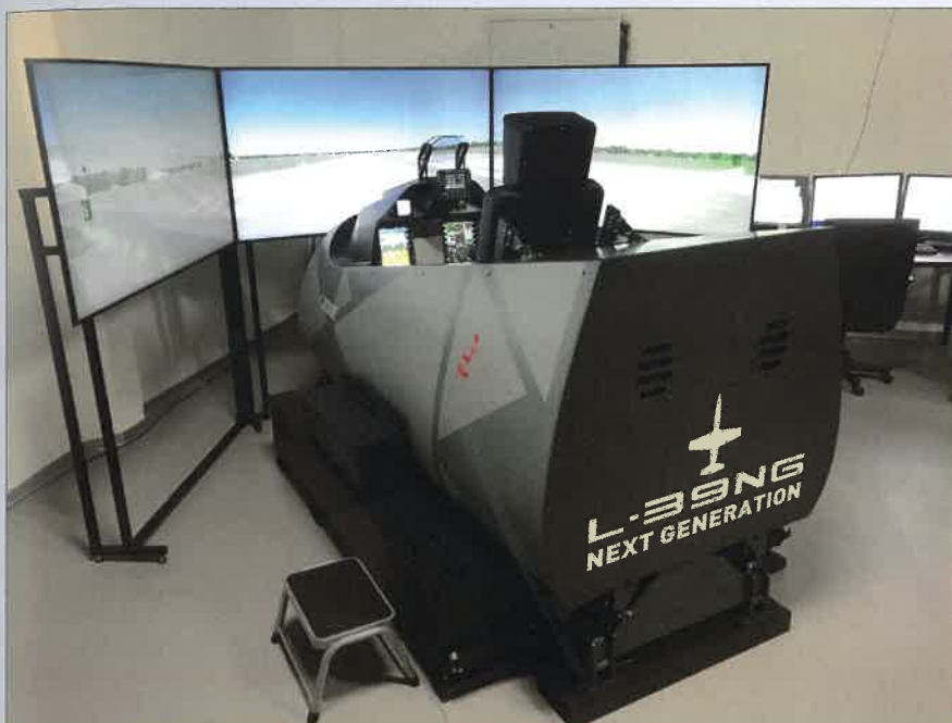
Společnost VR Group v listopadu představila nový letový simulátor FTD pro typ L-39NG
