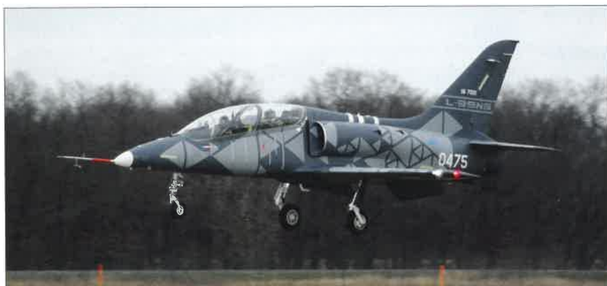
První prototyp L-39NG má nyní na přídi instalovánu trubkovou sondou se snímači vzdušných veličin
